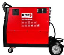
Soldador Inversor KTC Gmaw 250A , 410-MIG250AI, con alimentación 220V, salida máxima 250 amperios DC y tipo de procesos MIG+MAG+MMA compacto, ciclo de trabajo de 60% a 220V
