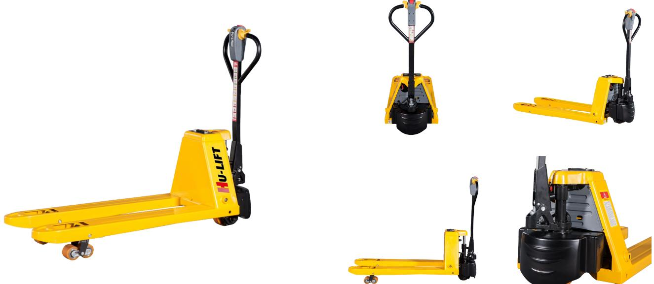
Gato Estibador Eléctrico Hu-Lift 2.0 Ton / 1.2 mt EPT20HT, 3895114, de desplazamiento por motor eléctrico, alimentado por una batería de litio de 10 AH, puede funcionar fácilmente hasta 4 a 5 horas por carga completa. A diferencia de muchos otros EPT en el mercado que utilizan un motor de accionamiento con escobillas de carbón de 24 V, este Estibador Eléctrico utiliza un motor sin escobillas potente y duradero de 48 V. Estibador – Gato Estibador – Paletera – Pallet – Paletizador – Paletizadora
