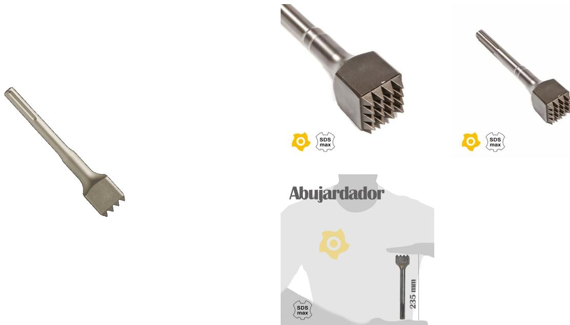
Cincel SDS Max Abuzardador 16D Bosch 45x400mm 3618630591, Elimina el exceso de concreto, produce un acabado rugoso exterior, Compatible con martillos SDS-max® de Bosch, atornillador a percusión SDS-max® de la competencia y martillos Hilti que usen vástagos TE-Y y TE-FY (se venden por separado), construcción maciza de la cabeza de 16 dientes.
