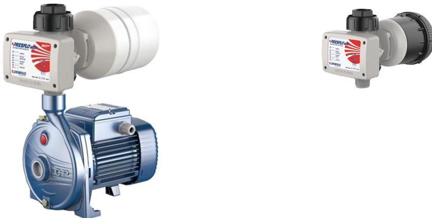
Sistema de Presión Automático Pedrollo Presflo Multi 220V 1F NKM 2/3 3-2-65 El regulador electrónico PRESFLO MULTI controla el arranque y parada de la electrobomba según la apertura y cierre del grifo. PRESFLO MULTI permite regular la presión de arranque (1-5 bar) y el control de corriente (4-16 A).
