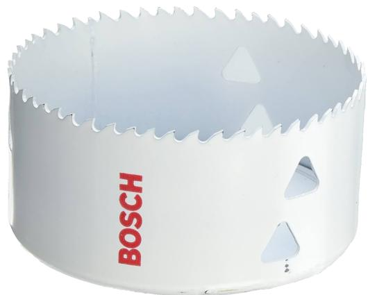
Sierra Copa Bimetálica Bosch 4Pulgadas HSS, 2608580440, se ajusta a todos los adaptadores estándar del mercado, realiza cortes parejos en varios tipos de materiales como madera, metal, acero inoxidable y varios materiales plásticos. La configuración de los dientes (tira de dientes Vario) es ideal para desplazarse a través del material y posibilita realizar cortes rápidos y precisos. Fabricada en HSS bimetálico con 8% de aleación de cobalto para realizar cortes de larga duración.
