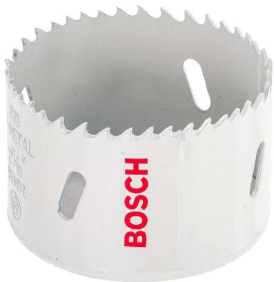
Sierra Copa Bimetálica Bosch 3Pulgadas HSS, 2608580432, se ajusta a todos los adaptadores estándar del mercado, realiza cortes parejos en varios tipos de materiales como madera, metal, acero inoxidable y varios materiales plásticos. La configuración de los dientes (tira de dientes Vario) es ideal para desplazarse a través del material y posibilita realizar cortes rápidos y precisos. Fabricada en HSS bimetálico con 8% de aleación de cobalto para realizar cortes de larga duración.
