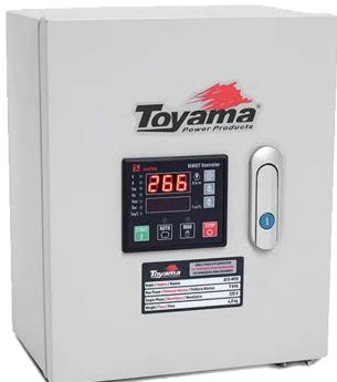
Interruptor de Transferencia Automática ATS 50A Toyama 251-074B-ATS (Automatic Transfer Switch) determina y enciende su grupo electrógeno de emergencia (Planta eléctrica) cuando hay fallas o ausencia en el sistema primario de energía (la red eléctrica), para grupos electrógenos hasta 8.5kVA marca Toyama.
