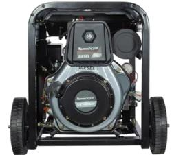
Motosoldador Diésel Abierto Toyama 11 kW 110/220V 1F 300AMP, TWGD220EXP 251-060, La Motosoldadora Toyama TWGD220EXP está equipada con un motor Toyama Diesel de 13,5 HP a 3.600 RPM, alternador monocilíndrico monofásico de 2 polos, refrigerado por aire, tipo "Brushless" con AVR y potencia nominal de 3,3 kVA. Produce hasta 220 amperios de salida CC con un ciclo de trabajo del 40 %.
