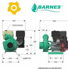
Motobomba Barnes Alta Presión 4 x 3, 15 Hp, 1E0295, Estructura en Hierro y Motor Gasolina Hi-Force, Equipos de trabajo pesado y continuo, Extracción de agua de pozos llanos y profundos, Lavado a presión de maquinaria, Lavado de establos, Llenado de tanques elevados, Riego por aspersión.
