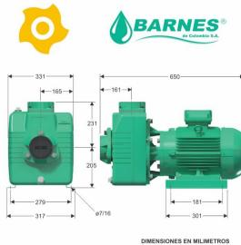
Electrobomba Barnes Autocebante 4 x 4, 7.5 Hp, 1D0510, Bombeo de agua con sólidos en suspensión, Desagüe de cajas telefónicas y eléctricas, Desagüe de zonas, inundadas, Industria Petrolera, Industria Petroquímica, Industria Química, Manejo de aguas residuales o negras, Manejo de combustibles, Plantas de tratamiento, Recirculación de agua en piscinas, Recirculación de agua en torres de enfriamiento, Riego de estiércol, Riego por aspersión, Riego por goteo, Riego por inundación.
