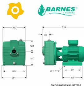
Electrobomba Barnes Autocebante 2 x 2, 3 Hp, 1D0501, Bombeo de agua con sólidos en suspensión, Desagüe de cajas telefónicas y eléctricas, Desagüe de zonas, inundadas, Industria Petrolera, Industria Petroquímica, Industria Química, Manejo de aguas residuales o negras, Manejo de combustibles, Plantas de tratamiento, Recirculación de agua en piscinas, Recirculación de agua en torres de enfriamiento, Riego de estiércol, Riego por aspersión, Riego por goteo, Riego por inundación.
