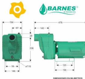
Electrobomba Barnes Autocebante 1½ x 1½, 1 Hp, 1D0047, Bombeo de agua con sólidos en suspensión, Desagüe de cajas telefónicas y eléctricas, Desagüe de zonas, inundadas, Industria Petrolera, Industria Petroquímica, Industria Química, Manejo de aguas residuales o negras, Manejo de combustibles, Plantas de tratamiento, Recirculación de agua en piscinas, Recirculación de agua en torres de enfriamiento, Riego de estiércol, Riego por aspersión, Riego por goteo, Riego por inundación.
