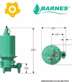
Electrobomba Barnes Aguas residuales, 1C0120, Trituradora tipo Grinder, 3.600 rpm, 1¼" Des 2 Hp, Estructura e Impulsor en Hierro fundido ASTMA-48, motor Eléctrico, ideal en Bombeo de agua con sólidos en suspensión, Control de niveles freáticos, Desagüe de zonas inundadas, Fuentes decorativas, Manejo de agua en beneficiaderos de café, Manejo de aguas, residuales o negras, Plantas de tratamiento, Pozos sépticos, Riego de estiércol.
