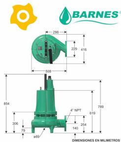
Electrobomba Barnes Aguas residuales, 1C0078, 1.800 rpm, 4" Des 4.5 Hp, Estructura e Impulsor en Hierro fundido ASTMA-48, motor Eléctrico, ideal en Bombeo de agua con sólidos en suspensión, Control de niveles freáticos, Desagüe de zonas inundadas, Fuentes decorativas, Manejo de agua en beneficiaderos de café, Manejo de aguas, residuales o negras, Plantas de tratamiento, Pozos sépticos, Riego de estiércol.
