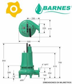
Electrobomba Barnes Aguas residuales, 1C0063, 1.800 rpm, 4" Des 11.3 Hp, Estructura e Impulsor en Hierro fundido ASTMA-48, motor Eléctrico, ideal en Bombeo de agua con sólidos en suspensión, Control de niveles freáticos, Desagüe de zonas inundadas, Fuentes decorativas, Manejo de agua en beneficiaderos de café, Manejo de aguas, residuales o negras, Plantas de tratamiento, Pozos sépticos, Riego de estiércol.
