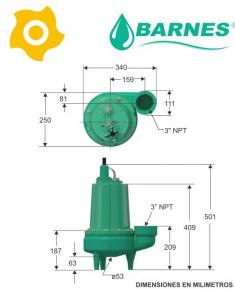
Electrobomba Barnes Aguas residuales, 1C0031, 1.800 rpm, 3? Des 0.75 Hp, Estructura e Impulsor en Hierro fundido ASTMA-48, motor Eléctrico, ideal en Bombeo de agua con sólidos en suspensión, Control de niveles freáticos, Desagüe de zonas inundadas, Fuentes decorativas, Manejo de agua en beneficiaderos de café, Manejo de aguas, residuales o negras, Plantas de tratamiento, Pozos sépticos, Riego de estiércol.
