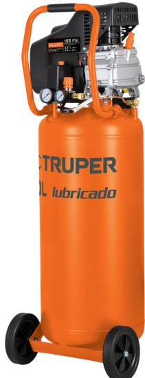
Compresor de Aire Lubricado Truper 3.5hp 80lt 15656, motor monofásico de 3 1/2 HP con bobinas de cobre, 2X mayor durabilidad que las de aluminio, presión máxima de operación 116 psi, cabeza con un pistón y filtro de aire metálico (roscable), protector térmico contra sobrecalentamiento de motor y cárter de aluminio para mayor disipación de calor, presostato con 2 manómetros de presión del tanque y presión regulable.
