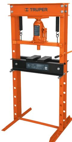
Presa Hidráulica 30 Ton Truper tipo H con gato de botella, 13739, estructura de acero, válvula de presión para sobrecargas, plancha ajustable a diferentes alturas, ideal para trabajos de doblado, enderezado y troquelado
