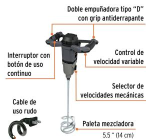
Mezclador Eléctrico de Pintura y Mortero Truper 1500W 101519, motor de 1500 W, montado sobre balero de bolas para mayor vida útil y mejor desempeño, caja de engranes de aluminio para mayor resistencia, selector de 2 velocidades mecánicas, velocidad variable para mayor control, mangos ergonómicos con grip antiderrapante.
