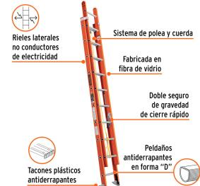
Escalera de Extensión Fibra de Vidrio Truper Tipo II 28E 8.2mt 175Kg, 100229, Fabricada en fibra de vidrio, doble seguro de gravedad de cierre rápido, sistema de polea y cuerda, peldaños antiderrapantes en forma «D», tacones plásticos antiderrapantes.
