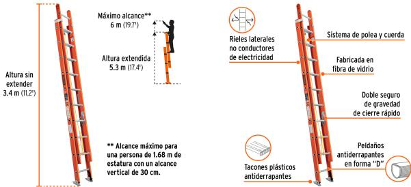
Escalera de Extensión Fibra de Vidrio Truper Tipo II 20E 5.8mt 175Kg, 100228, Fabricada en fibra de vidrio, doble seguro de gravedad de cierre rápido, sistema de polea y cuerda, peldaños antiderrapantes en forma «D», tacones plásticos antiderrapantes.
