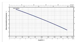
Electrobomba Pedrollo Drenaje Aguas Sucias 1½ Pulgada 0,5Hp 110V 1F, TOP2 Vortex, facilidad de uso y seguridad de funcionamiento gracias a la refrigeración total del motor y al doble sello del eje, profundidad de uso bajo el nivel de agua de hasta 3 m y un nivel de vaciado de hasta 25 mm desde el fondo, protección térmica del motor integrada en el bobinado y son aptas para un servicio continuo S1.
