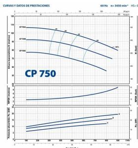
Electrobomba Pedrollo Centrífuga 2? Suc 2? Des 15 Hp 220V/440 3F, CP 750C-N, Bombeo de agua limpia, sin partículas abrasivas así como líquidos químicamente no agresivos con el material de construcción de la bomba. Con amplios usos en el sector agrícola, civil e industrial gracias a su simplicidad y fiabilidad, ideal para el suministro de agua y el montaje de acondicionamiento o de enfriamiento.
