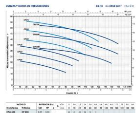
Electrobomba Pedrollo Centrífuga 1 ¼» Suc 1? Des 3 Hp 220V/440 3F, CP 670, Bombeo de agua limpia, sin partículas abrasivas así como líquidos químicamente no agresivos con el material de construcción de la bomba. Cuenta con amplios usos en el sector doméstico y civil especialmente en la distribución del agua acopladas a pequeños o medianos tanques autoclaves, como tambien para la irrigación de huertos. Su instalación se debe realizar dentro de alguna instalación o protegidos del exterior.
