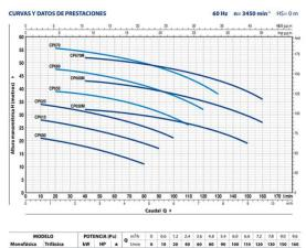
Electrobomba Centrífuga Pedrollo 1x1 1Hp 110V 1F CPm620, CPm620, Bombeo de agua limpia, sin partículas abrasivas así como líquidos químicamente no agresivos con el material de construcción de la bomba. Cuenta con amplios usos en el sector doméstico y civil especialmente en la distribución del agua acopladas a pequeños o medianos tanques autoclaves, como también para la irrigación de huertos.
