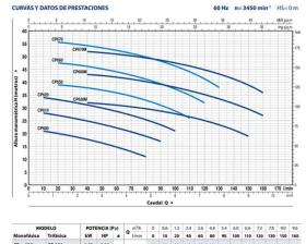
Electrobomba Pedrollo Centrífuga 1 ¼» Suc 1? Des 1,5 Hp 220V/1F, Cpm 650 220, Bombeo de agua limpia, sin partículas abrasivas así como líquidos químicamente no agresivos con el material de construcción de la bomba. Cuenta con amplios usos en el sector doméstico y civil especialmente en la distribución del agua acopladas a pequeños o medianos tanques autoclaves, como tambien para la irrigación de huertos. Su instalación se debe realizar dentro de alguna instalación o protegidos del exterior.
