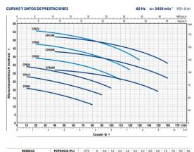
Electrobomba Pedrollo Centrífuga 1? Suc 1? Des 0,5 Hp 110V/1F, Cpm 600, Bombeo de agua limpia, sin partículas abrasivas así como líquidos químicamente no agresivos con el material de construcción de la bomba. Cuenta con amplios usos en el sector doméstico y civil especialmente en la distribución del agua acopladas a pequeños o medianos tanques autoclaves, como también para la irrigación de huertos. Su instalación se debe realizar dentro de alguna instalación o protegidos del exterior.
