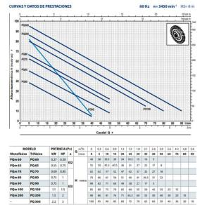
Electrobomba Pedrollo Periférica 1? Suc 1? Des 1,5 Hp, PQm 100, Bombeo de agua limpia, sin partículas abrasivas así como líquidos químicamente no agresivos con el material de construcción de la bomba. Sugieren su aplicación en el sector industrial o doméstico gracias a sus características hidráulicas, unidas a su tamaño reducido.
